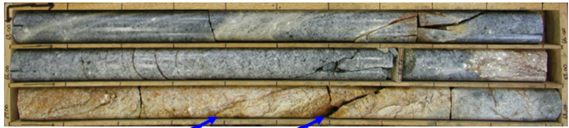
孔1:65-68m カタクレーサイトを伴う高角断層帯(65.70-70.55)の風化状況 高角の水みちに沿ってリモナイト沈積。
