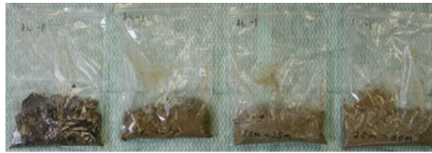
孔1:0-30mスライム 盛土(0-11m)・段丘(11-20m)・風化花崗斑岩(20-30m)
