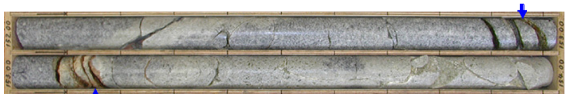
孔1:152-154m 割れ目沿いの風化状況 30° 傾斜の平行割れ目帯沿いに褐色化。
