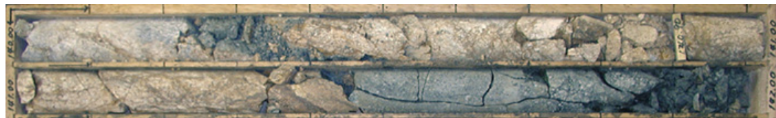
孔1:140-142m カタクレーサイトを伴う断層帯(132.10-147.90m)の風化状況 全体がカタクレーサイト
