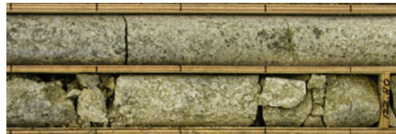
孔1: 121-123m (緑色変質) 有色鉱物が全て緑泥石化
